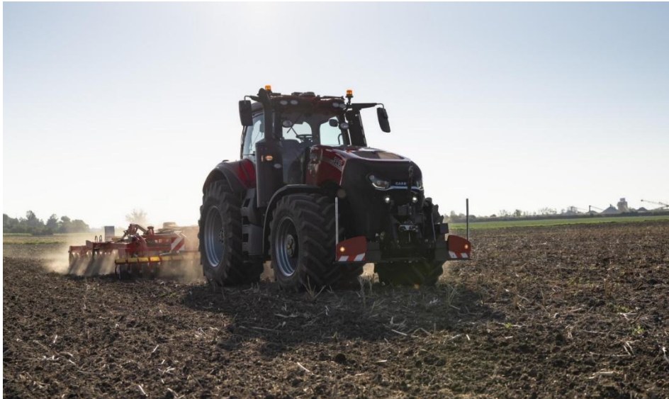
Abbildung 6: Case IH Magnum mit einer Nachrüslösung welche den Traktor autonom fahren lässt (Case IH 2023)
