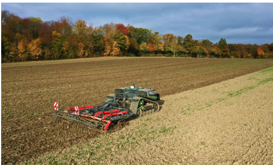
Abbildung 7: AgBot 5.112 bei der Bodenbearbeitung (AgXeed 2024)
